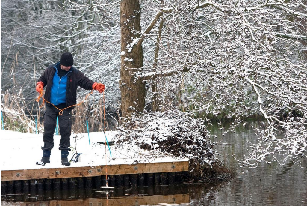
Figuur 2.5 Doorzichtmeting met de Secchi schijf
